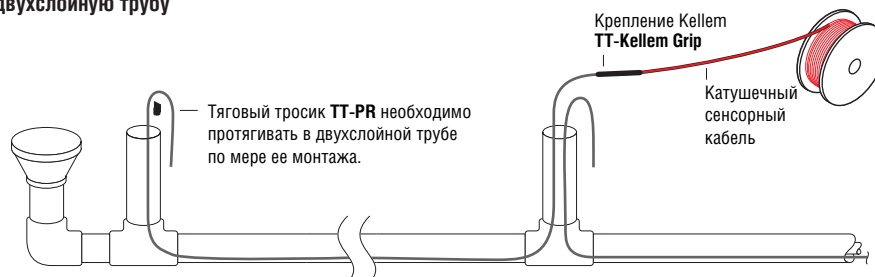
Рис. 6. Монтаж в двухслойную трубу
